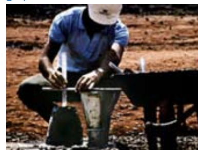
2 - Retire o cone, meça com a ajuda do mesmo qual é o abatimento do concreto.
