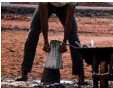
2 - Retire o cone, meça com a ajuda do mesmo qual é o abatimento do concreto.
