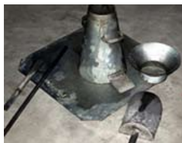
1 - Complete o interior do cone com concreto em 3 camadas, cada camada deve ser adensada com 25 golpes.
